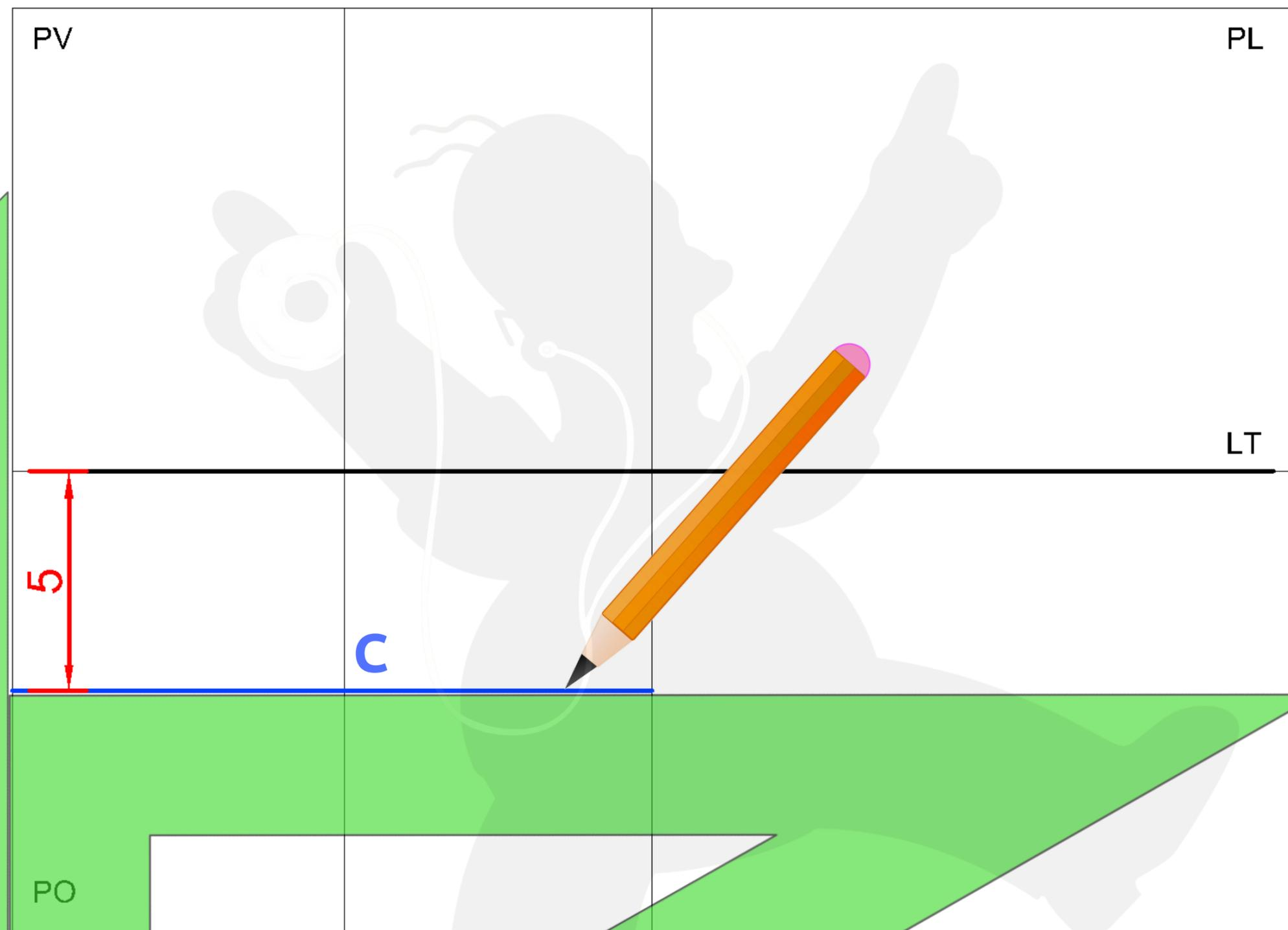
Traccia una **linea orizzontale** distante **5 cm** dalla linea di terra per trovare il **centro C** della base del cilindro
