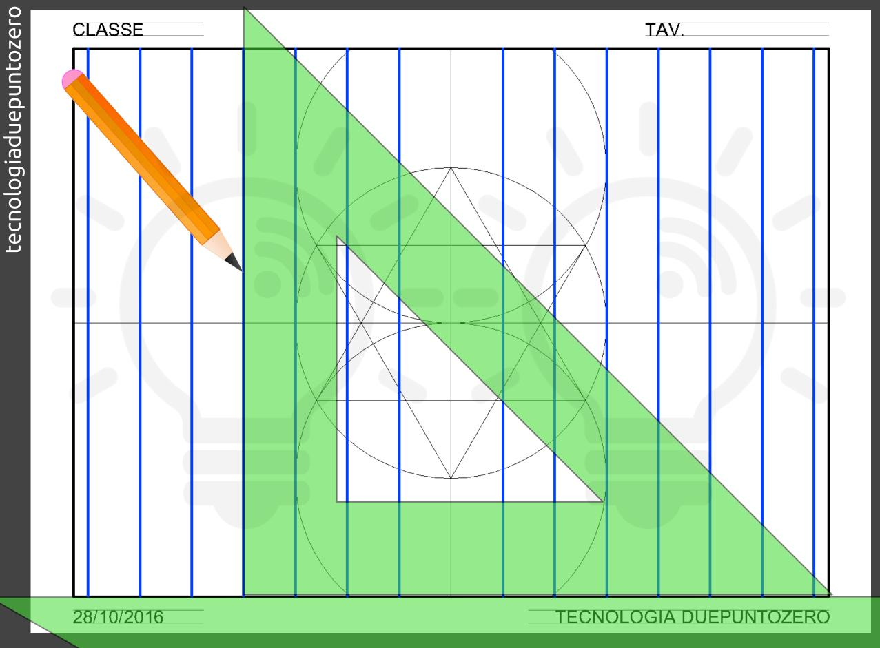
Usando correttamente le squadre, traccio delle linee verticali in corrispondenza di ogni puntino
